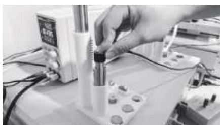
Рис.2 Надёжное прижатие зонда к поверхности измеряемого материала
